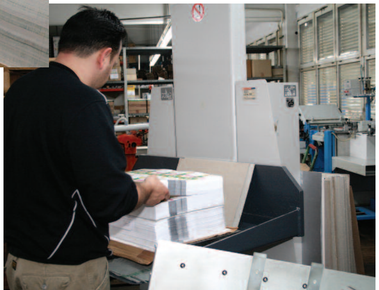
Die gedruckten Bögen werden für das Schneiden vorbereitet. ▶
