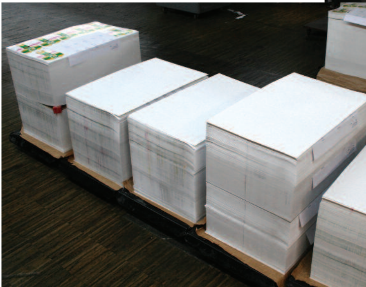
Die gedruckten Bögen werden, mit Pappe ▶ und Vorlage versehen, aus dem Drucker ent- fernt und zur Trocknung gestapelt. ▼
